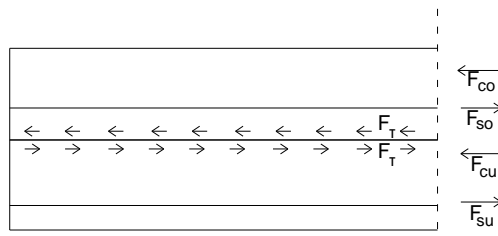
Σχήμα 3. Κατανομή δυνάμεων στην ενισχυμένη δοκό.
